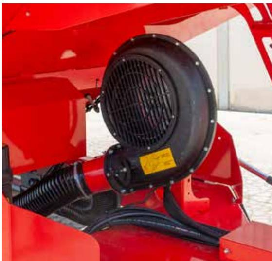
Turbina de accionamiento hidráulico de gran eficiencia.
