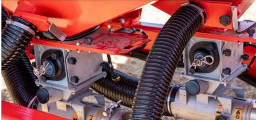
Distribuidores de acero inoxidable de fácil acceso y mantenimiento y sistema de vaciado rápido.
