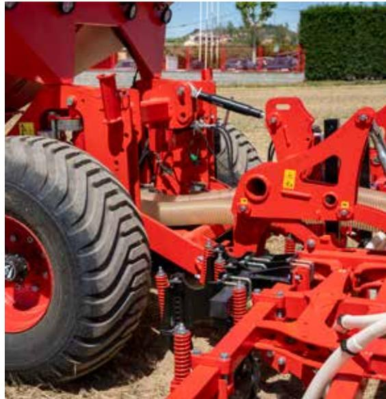
Tripuntal trasero de hasta 7.800Kg de capacidad de elevación.
