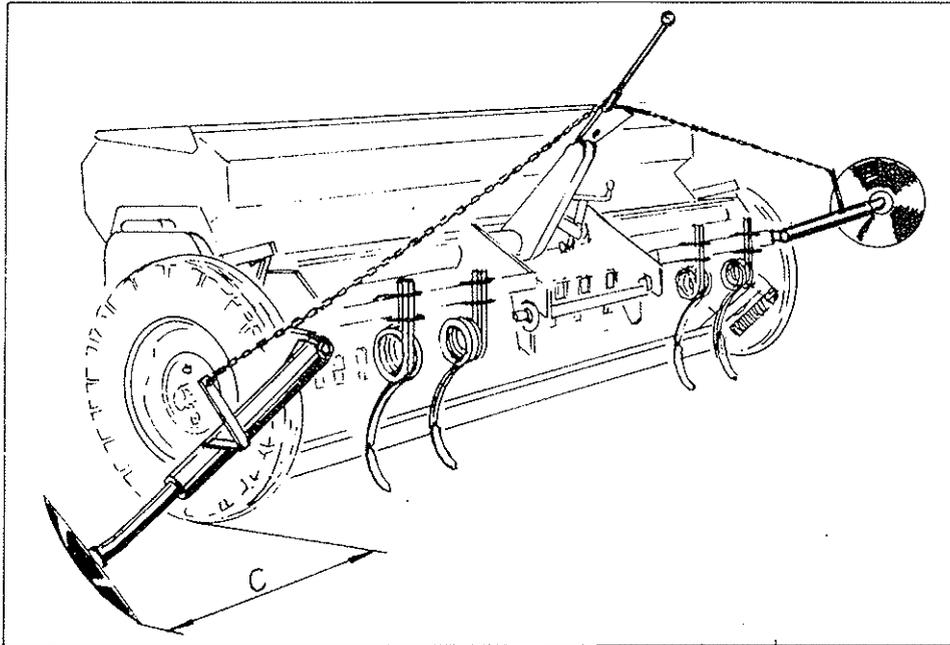
De construcción robusta, con discos cóncavos de 14", se acoplan a todas las medidas de máquinas ya que en cada extremo delantero del chasis, junto a las ruedas, está dispuesto un saliente plano con dos taladros para el amarre de los brazos trazadores y el trípode central dispone de un segundo taladro para la palanca del movimiento alternativo.
