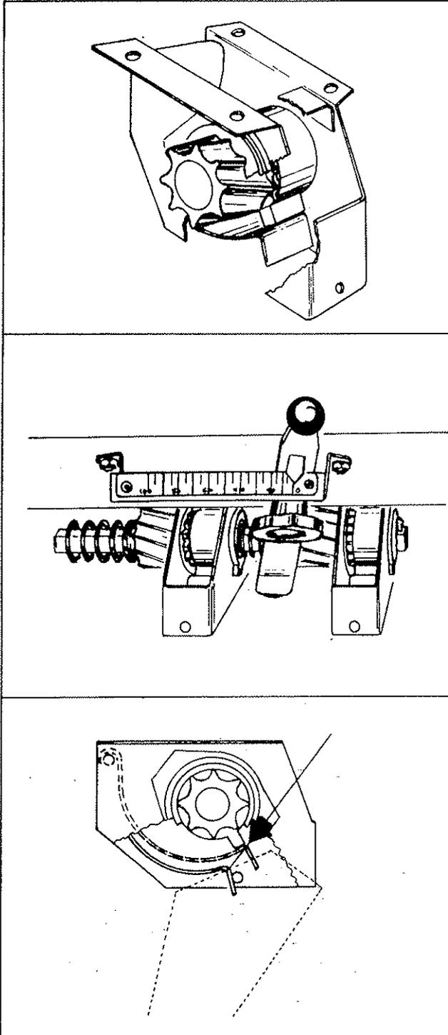
El rodillo acanalado sacagrano es de dentado helicoidal ofreciendo la máxima regularidad de siembra. El grano es acompañado al exterior, no forzado ya que el amplio paso del fondo, de tipo sifón, impide la rotura de granos.
