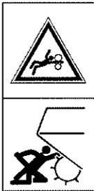
Peligro de lesiones graves por choque o aplastamiento con los discos y palas lanzadoras.
