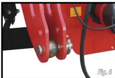
Colocar las bolas de enganche rápido en los dos bulones inferiores (fig.6).
