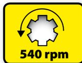
Sentido de giro y de velocidad de la toma de fuerza (sólo en máquinas con turbina de accionamiento mecánico).
