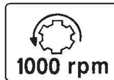
Sens de marche et vitesse de la prise de force (sur machines avec turbine à entra nement m canique)
