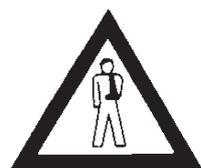
Como norma general, evite trabajar debajo de la máquina suspendida del tractor. Si debe hacerlo, asegúrela correctamente para evitar su desplome por pérdida de presión en el tractor.
