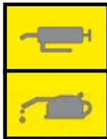
Mantenere in buone condizioni e ingrassate le parti della macchina dove sono presenti questi simboli lubrificazione e ingrassamento. Vedere sezione 9.2 PUNTI D'INGRASSAGGIO E LUBRIFICAZIONE
