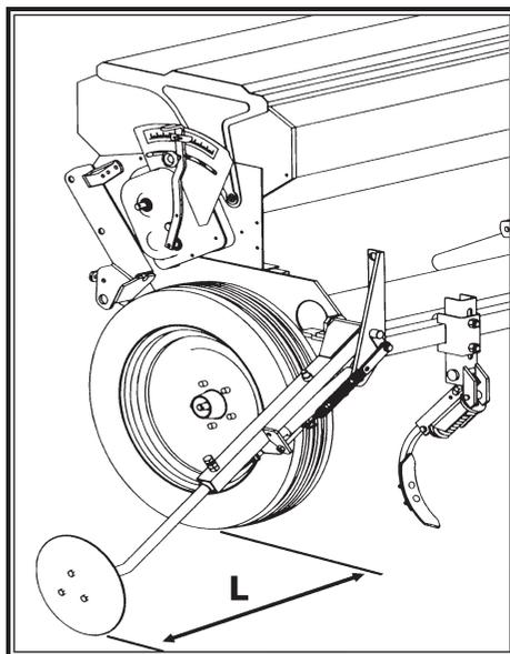
Los brazos de los trazadores son extensibles para su ajuste en longitud y los discos pueden orientarse para darles el ángulo de penetración adecuado. El descenso máximo se regula mediante los anillos que van montados en el émbolo del cilindro. Además, el muelle permite regular la presión del disco sobre el terreno. La distancia entre el disco y el exterior de la rueda (L, fig. 27) debe calcularse con la siguiente fórmula:
