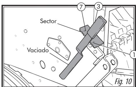
Finalmente, se suelta el pomo del variador, se desplaza la palanca sobre el sector graduado del 0 al 100 y se fija nuevamente sobre el número que previamente se habrá seleccionado (fig. 11) guiándose con las tablas de las páginas 36-37.
