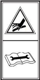
Posibilidad de penetración de fluido hidráulico a presión. Mantenga en buen estado las conducciones.
