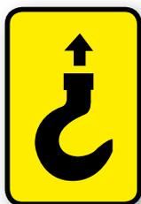
Punto de enganche para la manipulación de transporte mediante grúa.
