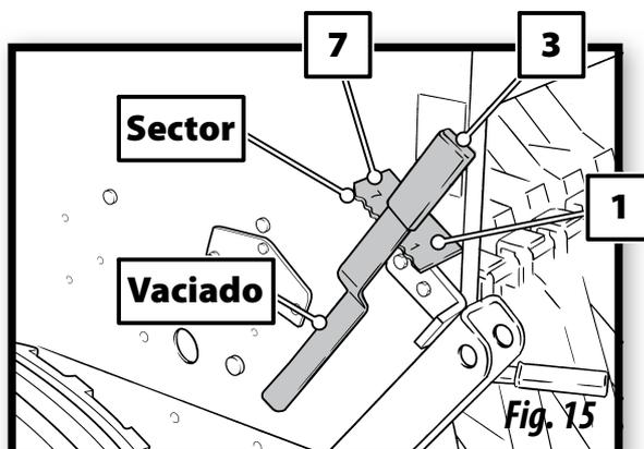
Finalmente, se suelta el pomo del variador, se desplaza la palanca sobre el sector graduado del 0 al 100 y se fija nuevamente sobre el número que previamente se habrá seleccionado (Fig. 16) guiándose con las tablas de dosificación.
