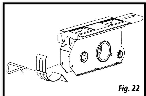
El fondo móvil del fertilizante lo constituye una tapeta, también de acero inoxidable, desmontable mediante un clip para facilitar su limpieza (Fig 22).
