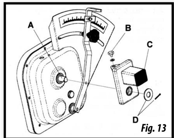
Soltando la tapa negra (C, Fig. 13) de la caja transparente quedará accesible el mando de puesta a cero.
