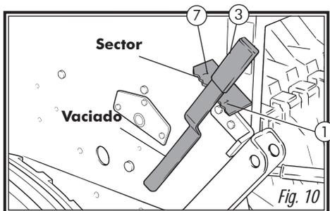
Pour vider la trémie, on doit placer l'auget sous les distributeurs et on doit faire bouger le levier jusqu'à dépasser le no 7. (fig.10).
