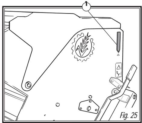
On règle la profondeur générale des ouvre sillons à socs de la façon montré antérieurement, mais à cause de la flexibilité pour s'adapter aux irrégularités du sol, ils n'ont pas besoin d'un contrôle spécifique comme dans le cas des bras élastiques ou des socs. En descendant le fus de profondeur ce sera correcte.
