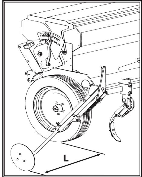
Les bras des traceurs sont extensibles. Ils peuvent se régler en longueur et les disques peuvent s'orienter pour avoir l'angle de pénétration correcte. La descente maximale des traceurs peut se régler à travers les bagues qu'il y a placées dans l'embolo du vérin. D'ailleurs, le ressort permet de régler la pression du disque sur le terrain. La distance entre le disque et la partie extérieure de la roue (L, fig. 27) doit se calculer avec la formule ci-après:
