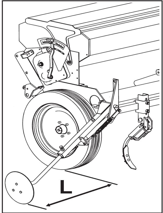
Les bras des traceurs sont extensibles. Ils peuvent se régler en longueur et les disques peuvent s'orienter pour avoir l'angle de pénétration correcte. D'ailleurs, sur l'exécution hydraulique, il y a des ressorts pour régler la pression du disque dur le terrain.
