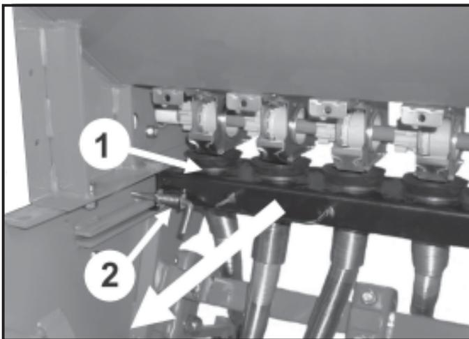
PREMIER: déplacer la barre porte manchons (1, fig. 19) en avant, en laissant les crochets qui la soutiennent en position de travail, jusqu'à la position qui permettra à l'auge de passer
