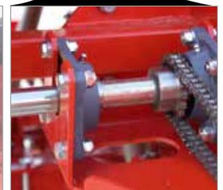
Deberán **LUBRICARSE** todas las cadenas de transmisión. Para realizar esta operación sacar las tapas de la transmisión (Fig. 7.10 y 7.11). Para extraer las tapas de la transmisión, véase el apartado 7.2.1 CADENA DE TRANSMISIÓN.
