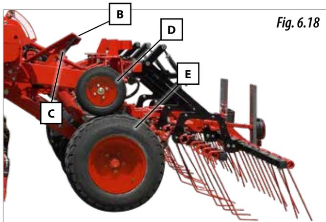
**EN HAUTEUR**, en agissant sur l'écrou supérieur du tendeur (B, Fig. 6.18).
