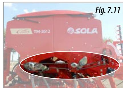
Il faut **LUBRIFIER** toutes les chaînes de transmission. Pour effectuer cette opération, enlever les couvercles de la transmission (Fig. 7.10 et 7.11). Pour ôter les couvercles de la transmission, voir le paragraphe 7.2.1 CHAÎNE DE TRANSMISSION.
