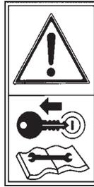
Antes de realizar trabajos de mantenimiento o reparación en la máquina, pare el motor del tractor y quite la llave del contacto.
