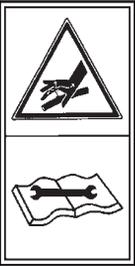
Mantenga en buen estado las conducciones hidráulicas. **Peligro de lesiones graves.**
