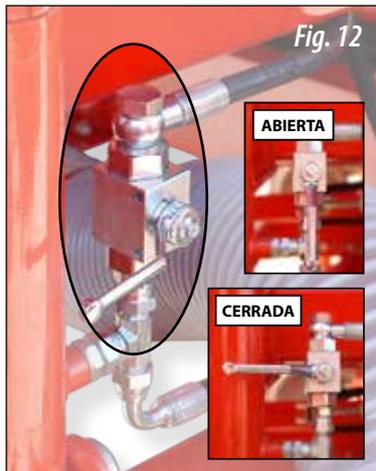
Para las versiones de la máquina con borrahuellas, este elemento puede excluirse actuando sobre la llave de paso (Fig. 12) ubicada entre la tolva y el equipo de siembra. Véase en la imagen las posiciones de la llave, siendo: **ABIERTA**: para incluir el borrahuellas, y **CERRADA**: para excluir el borrahuellas.
