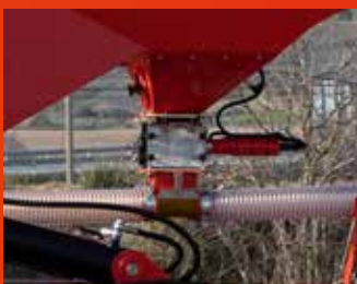
Дозирующее устройство с электрическим приводом, не требующее технического обслуживания.
