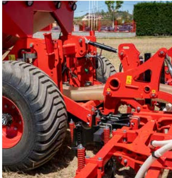
Attelage arrière à trois points avec une capacité de relevage allant jusqu'à 7 800 kg.
