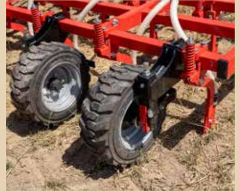
Roues de contrôle de la profondeur réglables.
