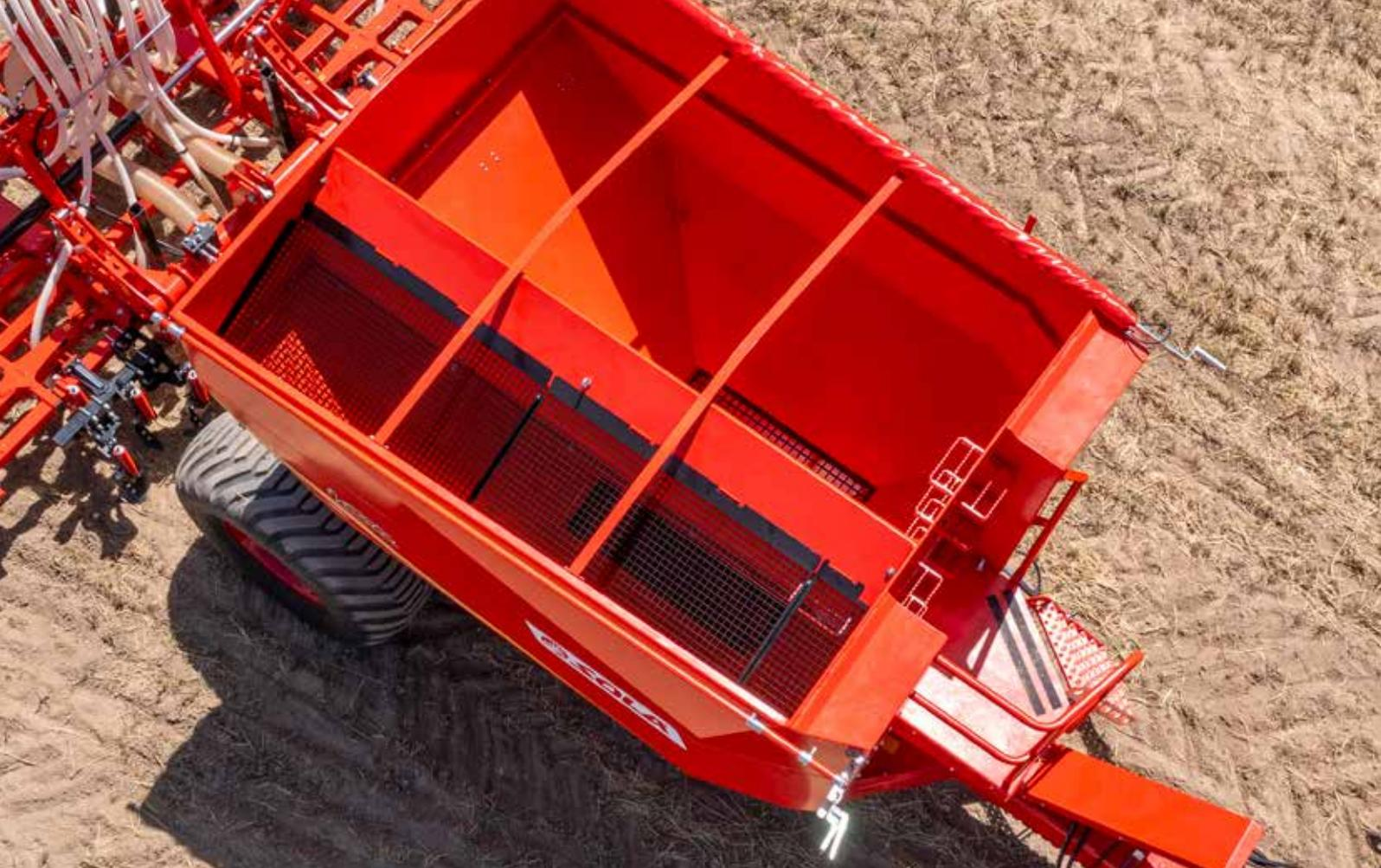
Trémie de grande capacité divisée 60/40% pour les semences et le engrais.
