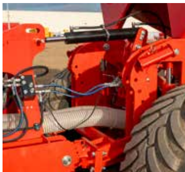
Attacco a tre punti posteriore con capacità di sollevamento fino a 7.800 kg.
