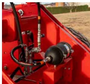
Sistema di ammortizzazione del sollevatore per un trasporto sicuro.
