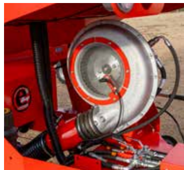
Turbina ad azionamento idraulico ad alta efficienza.
