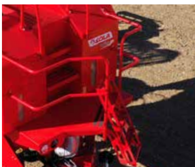
Scala di accesso alla piattaforma. Finestre di ispezione.
