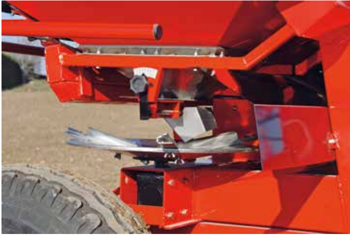
-MANDO REGULADOR DE BOQUILLA DE CAIDA DE ABONO AL DISCO
