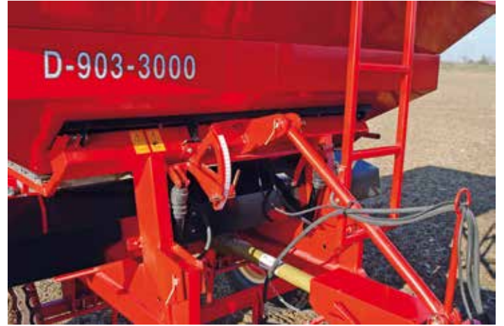
-MANDO HIDRÁULICO DE APERTURA Y CIERRE
