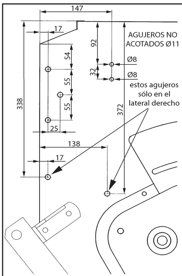
En las tolvas SOLÀ de gran capacidad (GC), el cierre central de la tapa de la tolva de semilla debe ser substituido por dos cierres laterales. Para su montaje es necesario practicar agujeros de  $\varnothing 8$  en los laterales de la tapa y de la tolva.
