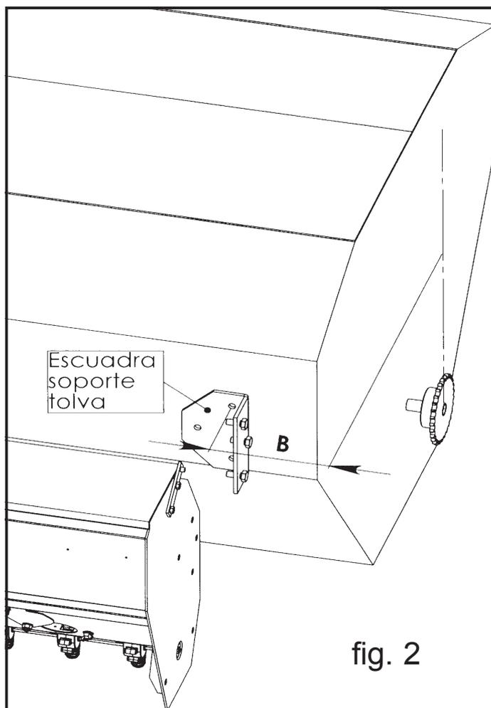
En otras marcas deberemos colocar primero la escuadra soporte tolva a la altura deseada y a una distancia B del piñón motriz de la máquina (figura 2) para asegurar que la transmisión se alinearé correctamente.
