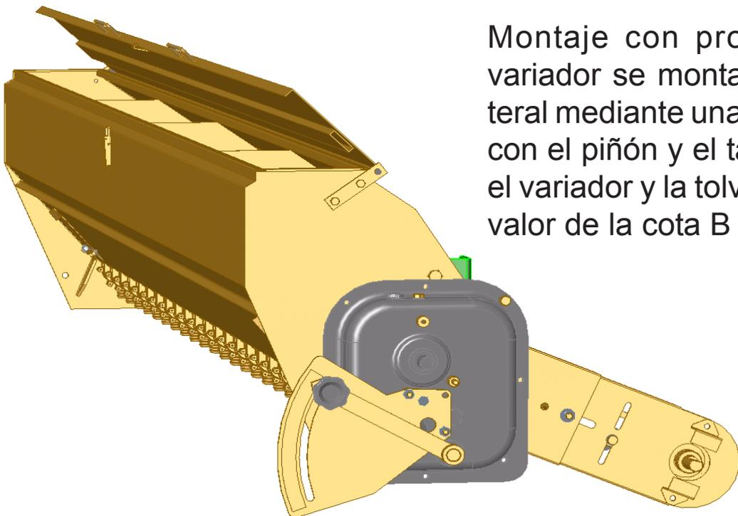
Montaje con prolongaciones. El variador se monta separado del lateral mediante unas prolongaciones, con el piñón y el tapacadenas entre el variador y la tolva. En este caso el valor de la cota B es de 140 mm.
