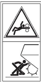
Gefahr von schweren Verletzungen mittels Zusammenstoß oder Erdrückung durch Wurfscheiben und Schaufeln.
