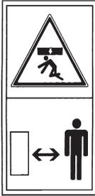
Erdrückungsgefahr, wenn Sie unter der Maschine arbeiten. Muss abgesichert werden, um ein Umkippen zu verhindern. Gefahr schwerer Verletzungen.
