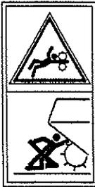
Restre à distance des pièces en rotation de la machine. Ne pénétrer jamais dans la zone de rotation lorsque le moteur tourne et que la prise de force est enclenchée.
