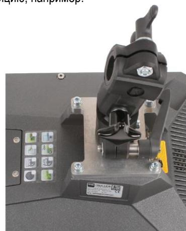
4. Закрепите терминал в кабине транспортного средства. Используйте для этого, например, основную консоль ME. Она относится к объему поставки основного оборудования ISOBUS.
