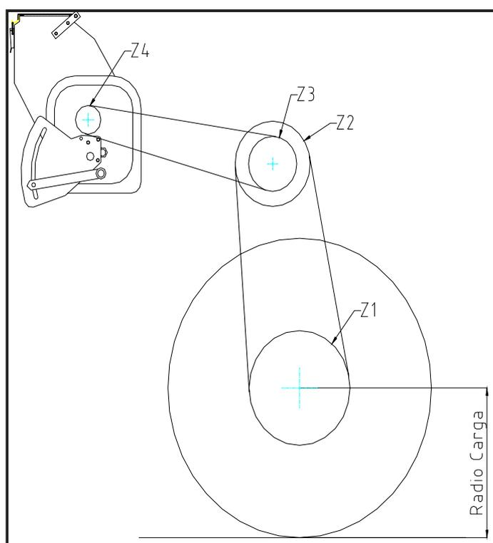
Estos valores, comprendidos entre 0,93 y 2,22, nos indican el número de vueltas del eje de entrada del variador por cada vuelta de la rueda de la sembradora.
