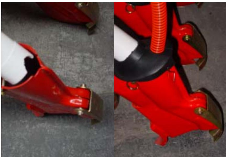
Fig. 20 - Sembradora EURO: recortar el tubo telescópico, soldar el suplemento, taladrar el tapabotas y montar el conjunto.
