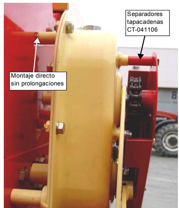
También es posible montar el variador en el lado izquierdo de la máquina (según el sentido de la marcha). En la figura 17 se muestran las diferencias de orientación y montaje del graduador respecto al montaje en el lado derecho. La pegatina del graduador también debe sustituirse.
