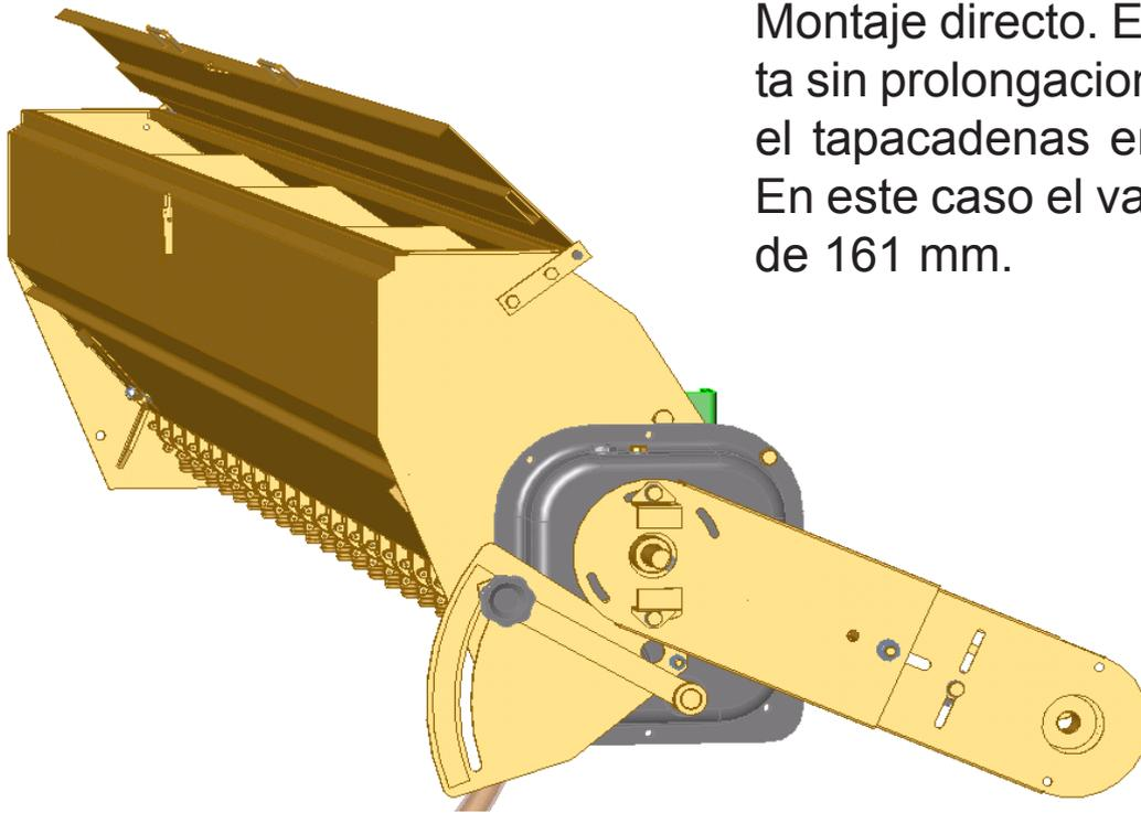
Montaje directo. El variador se monta sin prolongaciones, con el piñón y el tapacadenas en la cara exterior. En este caso el valor de la cota B es de 161 mm.
