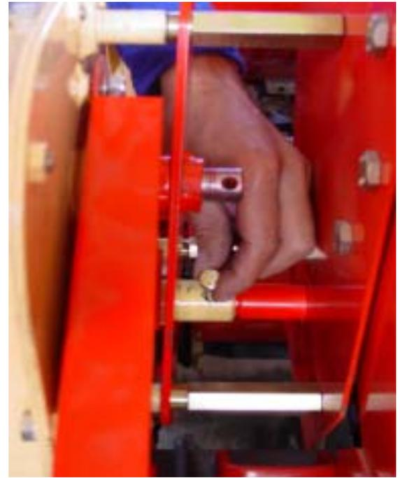
Figs. 15 y 16 - Cuando efectuemos un montaje sin prolongaciones, usaremos el manguito de acoplamiento corto para unir el variador al eje hexagonal de los distribuidores. La cadena de transmisión se monta por el exterior del variador y el tapacadenas precisa de separadores.
