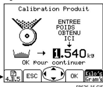
4. Presser VALIDER encore une fois, et la console re-calcule et affiche le nouveau facteur de CALIBRAGE en kg/rev, le % d'erreur, et la vitesse d'avancement maximale permise calculée en fonction de la dose d'application réglée pour le produit (fig.5).
