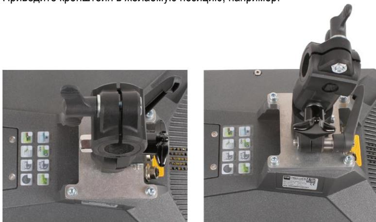
4. Закрепите терминал в кабине транспортного средства. Используйте для этого, например, основную консоль ME. Она относится к объему поставки основного оборудования ISOBUS.
