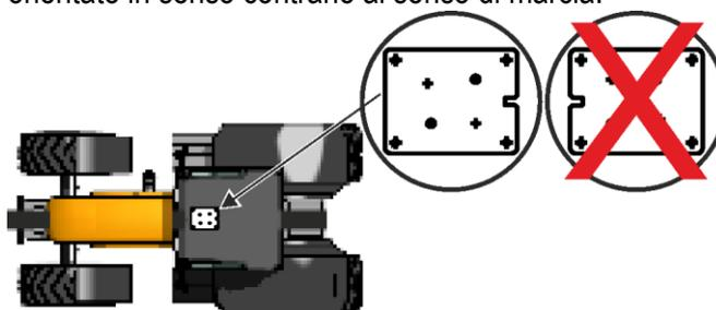
4. Fissare il ricevitore GPS sul supporto magnetico, fino al suo innesto. Il connettore deve essere orientato in senso contrario al senso di marcia.
