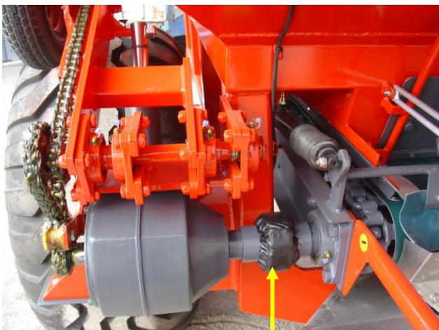
Снять защиту и отсоединить цепи соединения.
