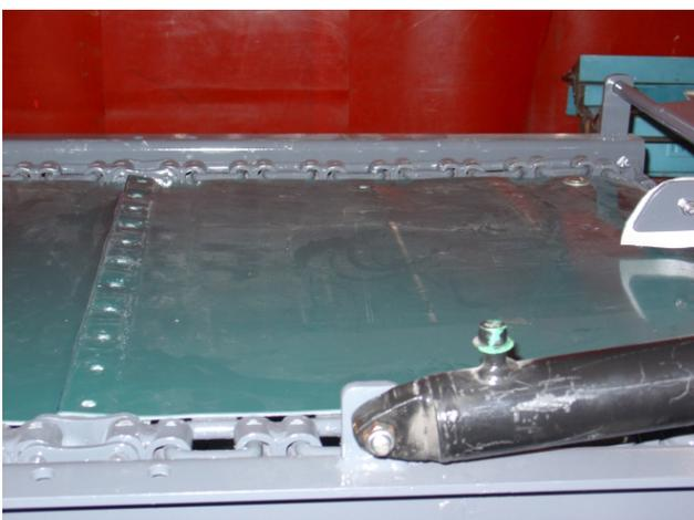
Прокрутить ленту и соединить её сверху другой на поперечине(если длинная то отрезать), просверлить, соединить болтами, отпустить натянутую цепь.
