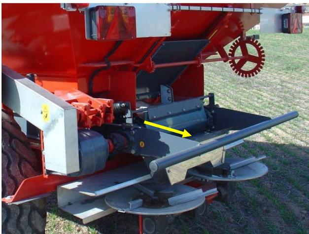
Вытащить дозирующую емкость, один раз отсоединивши всё,вытащить назад ленточную тележку.
