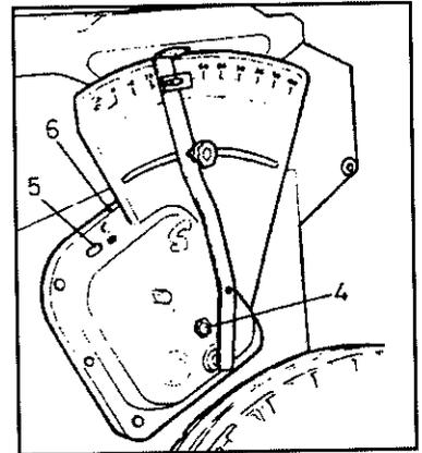
Controlar el nivel del VARIADOR a través de la mirilla (4) y si es necesario completar con aceite SAE-30 por el tapón (5)
