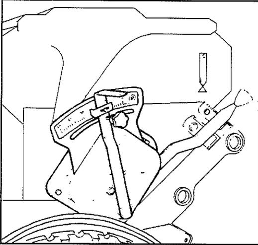
La dosificación del fertilizante se efectúa mediante el VARIADOR situado a la izquierda de la máquina, desplazando el brazo flecha sobre la placa numerada del 0 al 50 y fijándola sobre el número que previamente se habrá seleccionado por la Tabla de dosificación de la página 30.
