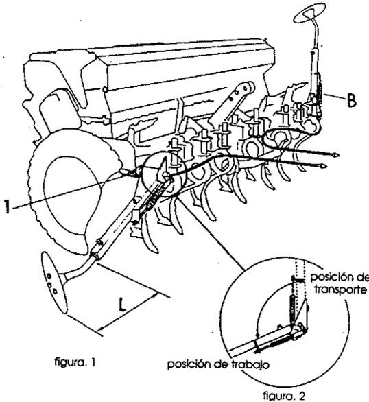
Los brazos de los trazadores son extensibles para su ajuste en longitud y los discos pueden orientarse para darles el ángulo de penetración adecuado. Además en la ejecución hidráulica se han dispuesto unos muelles complementarios -B- que permiten regular la presión del disco sobre el terreno.
