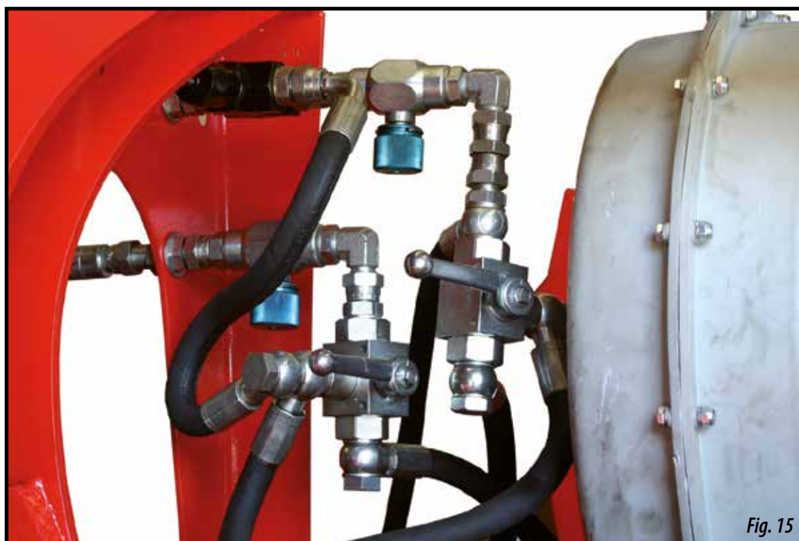
Posición de los grifos para la ABERTURA y CIERRE de las alas.
