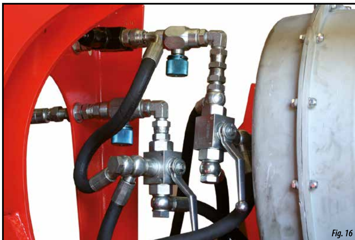
Posición de los grifos para el ACCIONAMIENTO del sinfín.
