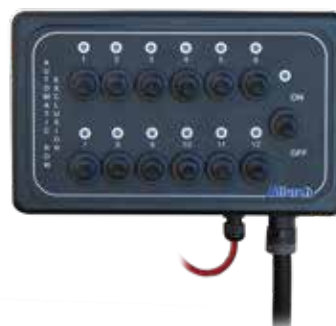
Excluderea automată a rândurilor direct din cabina tractorului.
