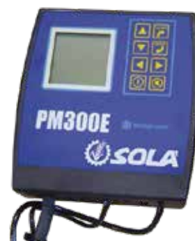
Contor pentru suprafețe, controlul vitezei, controlul nr. de semințe pe hectar, distanța dintre semințe, alarmă pentru densitatea semințelor pe fiecare rând.
