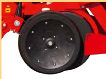
Roues de jauge indépendantes de 5" avec des grattoirs. Two independent control depth wheels of 5" with scrapers.
