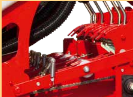
Exclusion de l'élément. Switch trigger for element exclusion
