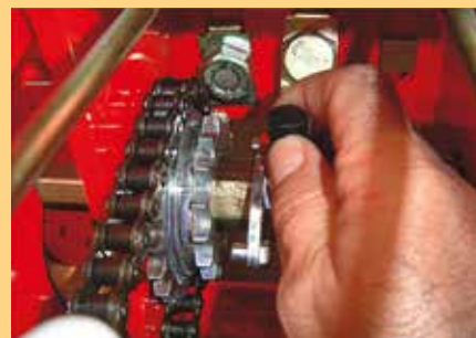
Coupure de rangs manuelle sur chaque élément. Manual sowing exclusion on each element
