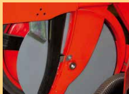
Double disque ouvreurs avec deux grattoirs sur chaque disque. Double furrow opener discs with two scrapers each.
