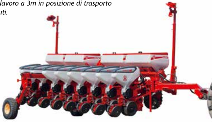
Con transporte de punta el ancho es de 3m. / Con telaio fisso e trasporto longitudinale con larghezza di trasporto di 3m.
