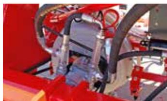
▲ -TURBINA CON MOTOR HIDRÁULICO.
