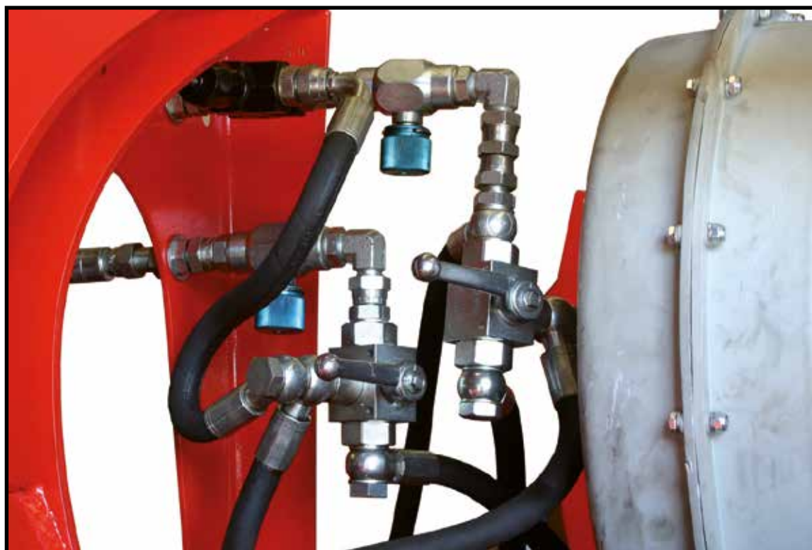
Position des vannes pour l'ENTRAÎNEMENT de la vis sans fin.
