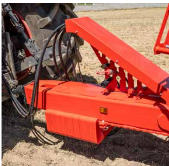
Contrappesi e sistema di guida dei tubi flessibili.
