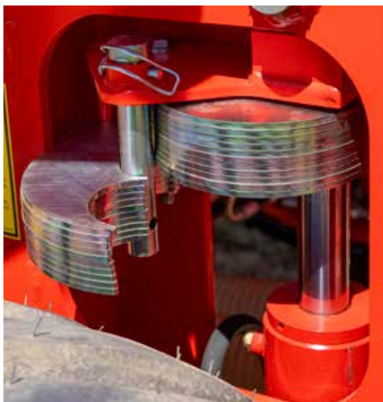
Regolazione idraulica del sollevatore.
