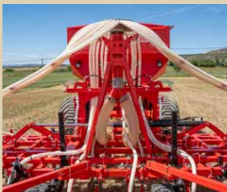
Testata di distribuzione. Uniformità del flusso.
