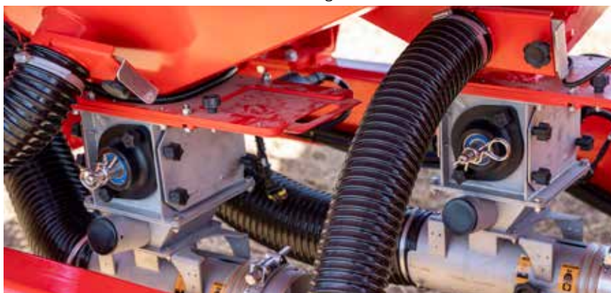
Distributori in acciaio inox di facile accesso e manutenzione e sistema di svuotamento rapido.
