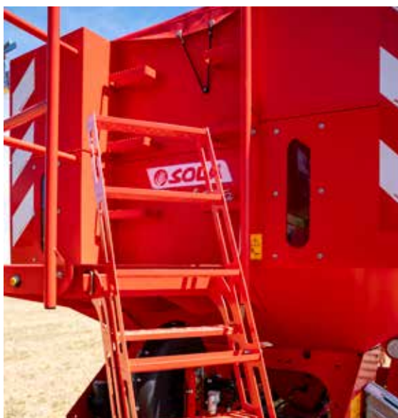
Scala di accesso alla piattaforma. Finestre di ispezione.
