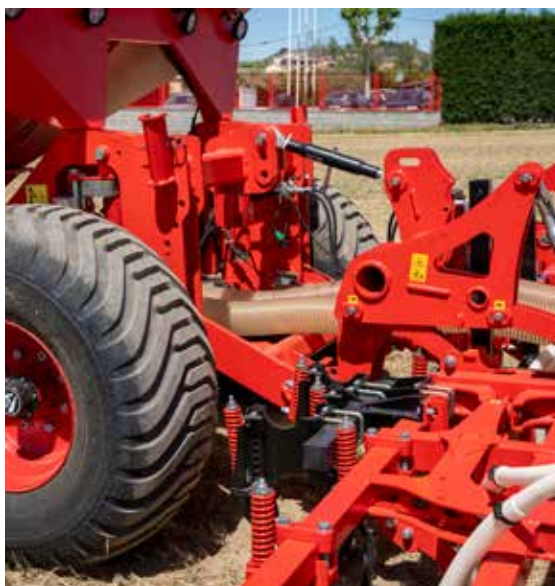
Attacco a tre punti posteriore con capacità di sollevamento fino a 7.800
