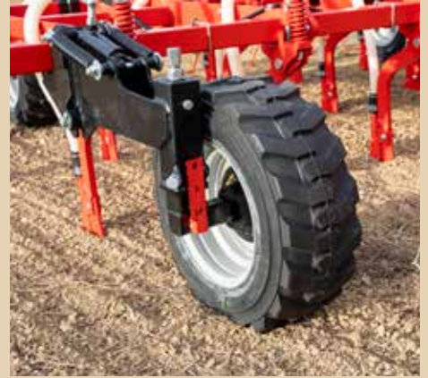
Ruedas de control de profundidad regulables.
