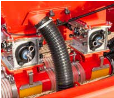
Distribuidores de acero inoxidable de fácil acceso y mantenimiento y sistema de vaciado rápido.
