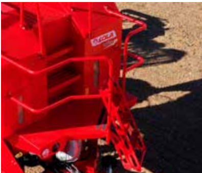
Escalera de acceso a plataforma. Ventanas de control.
