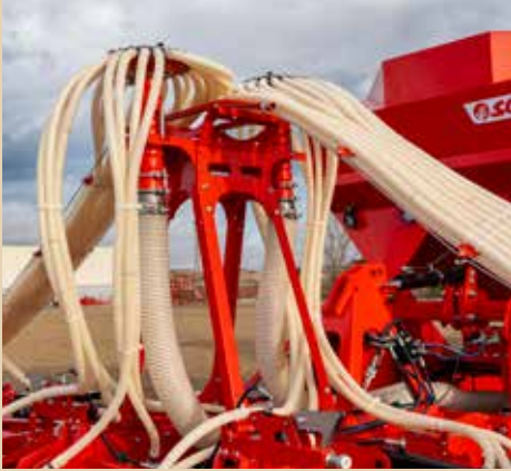
Doble cabezal para cierre de media máquina.
