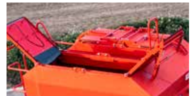
Bocas de carga de cierre hermético con tapas redondas o rectangulares
