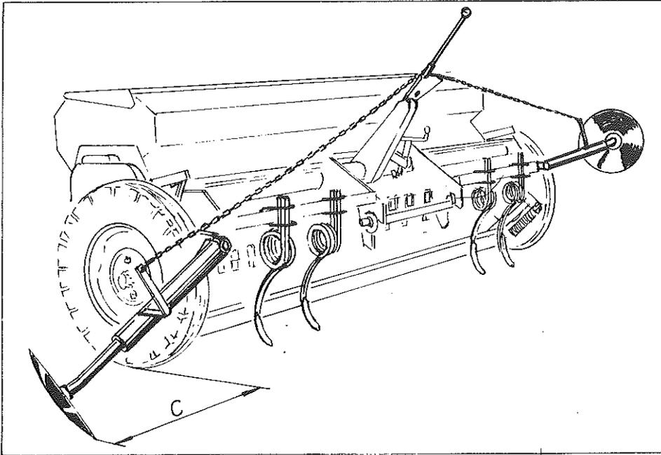
De construcción robusta, con discos cóncavos de 14", se acoplan a todas las medidas de máquinas ya que en cada extremo delantero del chasis, junto a las ruedas, está dispuesto un saliente plano con dos taladros para el amarre de los brazos trazadores y el trípode central dispone de un segundo taladro para la palanca del movimiento alternativo.
