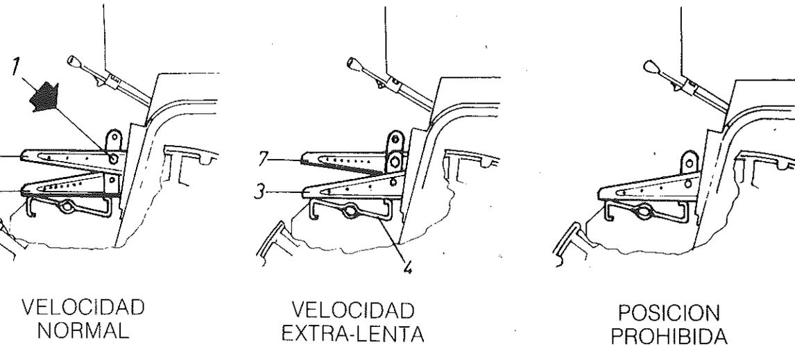
Para semillas pequeñas, alfalfa, trébol, veza, etc. de pocos kilos por hectárea debe cerrarse el distribuidor casi totalmente de forma que sólo actúe el dentado fino del rodillo y conectar la velocidad lenta.
