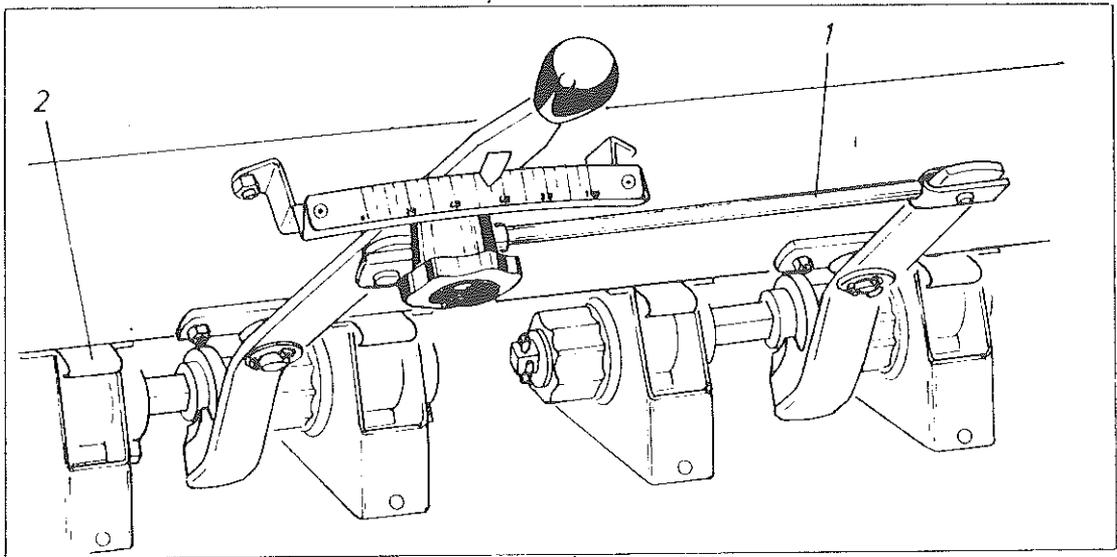
En la Combinada cada distribuidor va provisto de una trampilla (2) que permite cerrar o abrir individualmente todo el caudal. No olvidar de abrirlas al iniciar la siembra.
