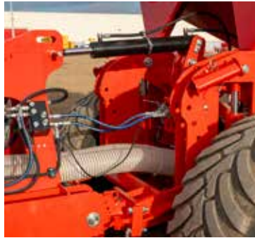
Attelage arrière à trois points avec une capacité de relevage jusqu'à 7 800 kg.
