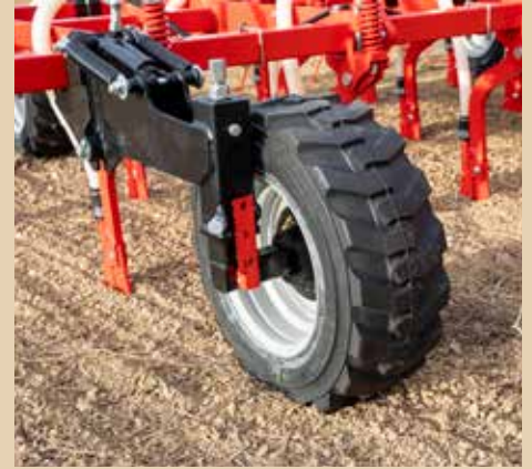
Roues de contrôle de la profondeur réglables.
