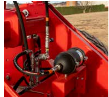
Amortisseur de levage pour un transport en toute sécurité.
