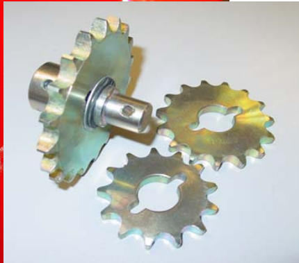
EJE CON DISCOS INTERCAMBIABLES PARA MODIFICAR LA DOSIS.
