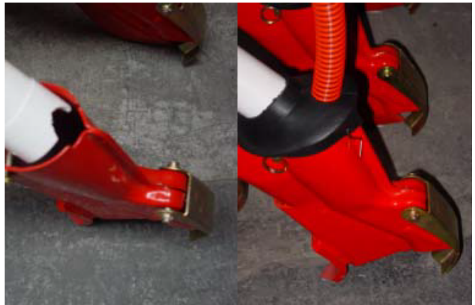
Fig. 20 - Sembradora EURO: recortar el tubo telescópico, soldar el suplemento, taladrar el tapabotas y montar el conjunto.
