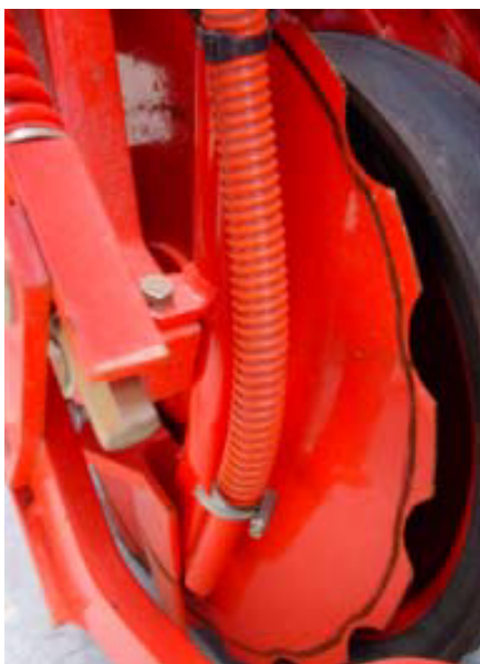
Fig. 21 - Sembradora SD-1203: soldar el suplemento al tubo de descenso de semilla.
