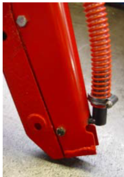
Fig. 22- Sembradora 395-SD: soldar el suplemento a la bota
