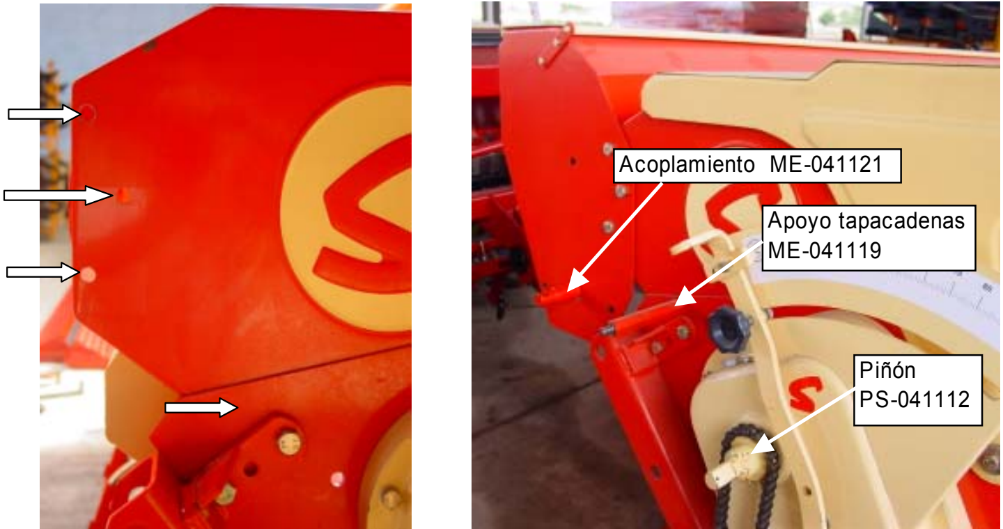
Fig. 10 y 11 - Se taladran los agujeros de \varnothing 11 en los laterales de la tolva de semilla para poder montar la tolva de microgranulados, el acoplamiento largo del variador, el apoyo del tapacadenas y el piñón de salida del variador de la máquina.
