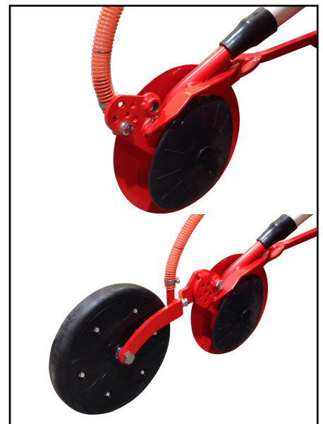
Fig. 22-A - Sembradora ED-1003: Montar el suplemento en los agujeros estipulados.
