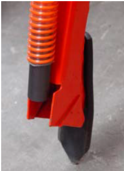
Fig. 19 - Sembradora TRISEM: soldar el suplemento a la bota.
