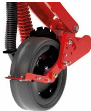
Однодисковый дозатор удобрений
