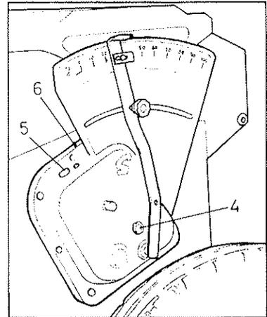
Controlar el nivel del VARIADOR a través de la mirilla (4) y si es necesario completar con aceite SAE-30 por el tapón (5)
