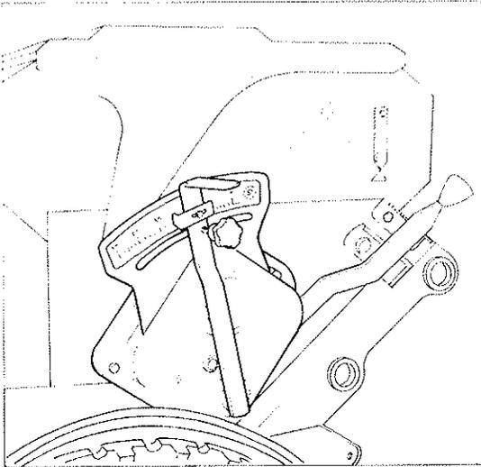
La dosificación del fertilizante se efectúa mediante el VARIADOR situado a la izquierda de la máquina, desplazando el brazo flecha sobre la placa numerada del 0 al 50 y fijándola sobre el número que previamente se habrá seleccionado por la Tabla de dosificación de la página 24.
