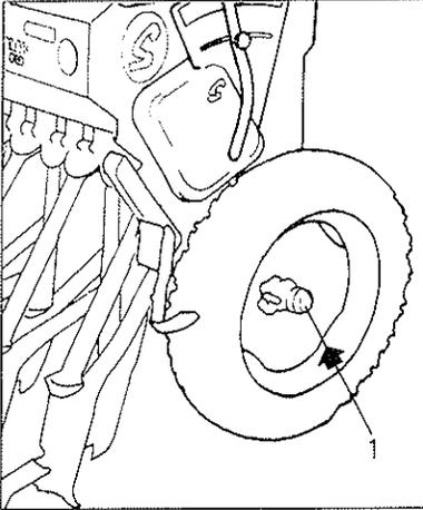
1.- Bujes de las ruedas, soltando el tapón, que viene ajustado a presión, sin rosca: grasa consistente cálcica.
