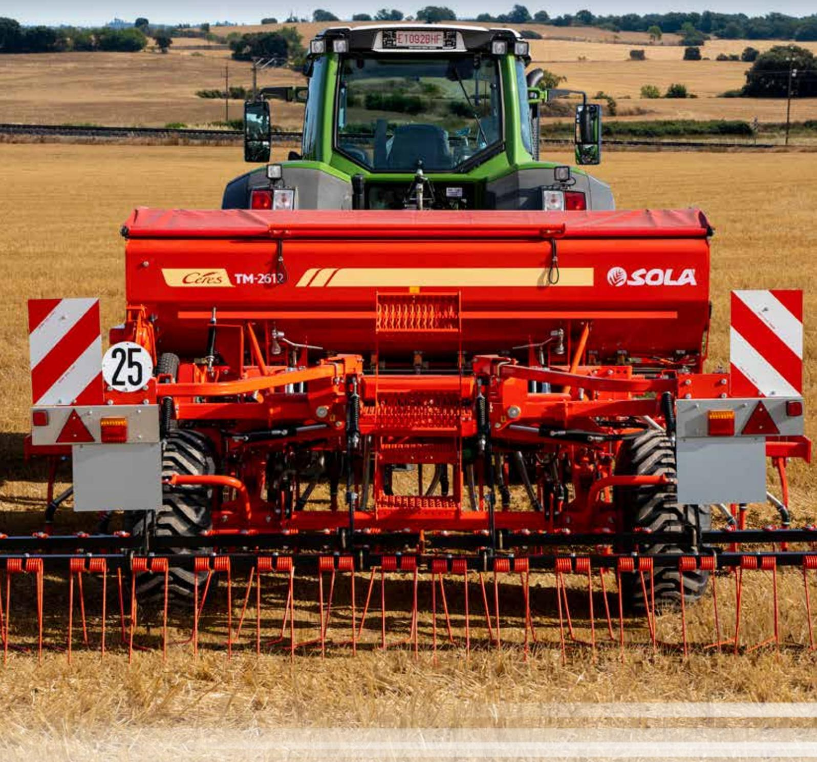
Sistema telescópico de plegado de equipo de siembra. De 3 m en posición de transporte a 4 m en posición de trabajo.
