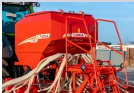
Tramoggia pressurizzata da 2.000 litri.
