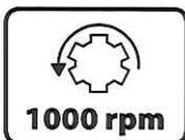
Sentido de giro y de velocidad de la toma de fuerza (sólo en máquinas con turbina de accionamiento mecánico).
