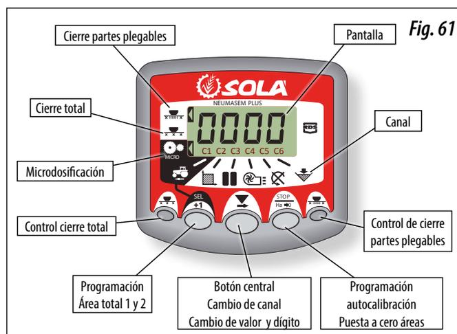
El monitor sale de fábrica programado para la sembradora en la que está montado. Por lo tanto solo debe visualizar los valores y no hace falta entrar en programación.
