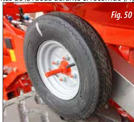
3- Recorra con la sembradora en posición de trabajo la mencionada distancia. De ese modo, obtenemos el verdadero número de vueltas a dar en el ensayo previo de caudal. Realizando el ensayo con este número de vueltas, obtendremos los kilos por hectárea que realmente reparte la máquina.
