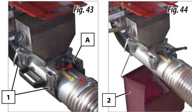
4- Girar la maneta para liberarla (A, Fig. 43) y desplazarla hasta la posición "NO" (posición de ensayo).
