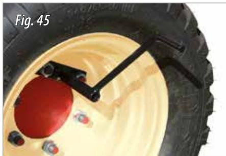
6- A continuación, coloque la manivela (fig. 45) en la rueda derecha de la sembradora.
