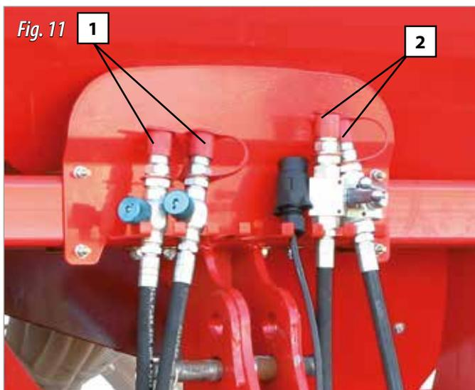
Para el **DESPLIEGADO Y PLEGADO DE LA MÁQUINA** (1, fig. 11):
