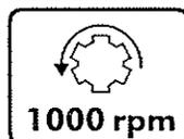
Sentido de giro y velocidad de la toma de fuerza (sólo en máquinas con turbina de accionamiento mecánico)
