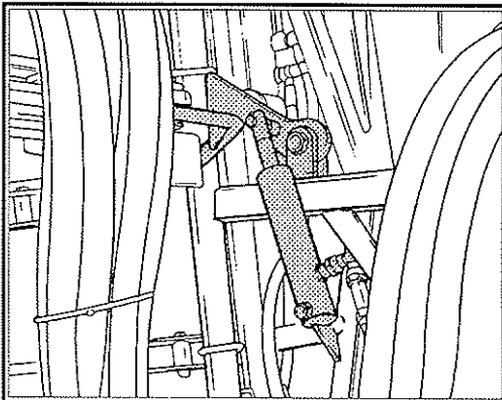
Estas operaciones se realizan mediante cilindros hidráulicos gobernados por electroválvulas.
