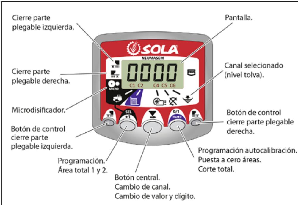
El monitor sale de fábrica programado para la sembradora en la que está montado. Por lo tanto solo debe visualizar los valores y no hace falta entrar en programación.
